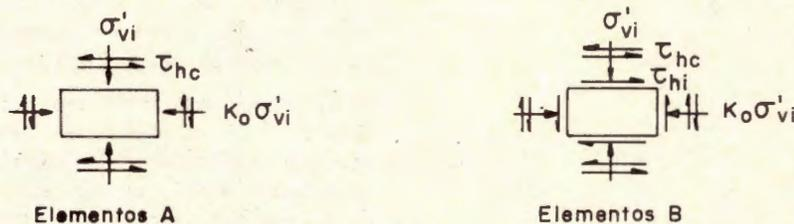
Fig. 1.- Estado tensional de elementos de suelo in situ en distintas condiciones de carga cíclica horizontal.
