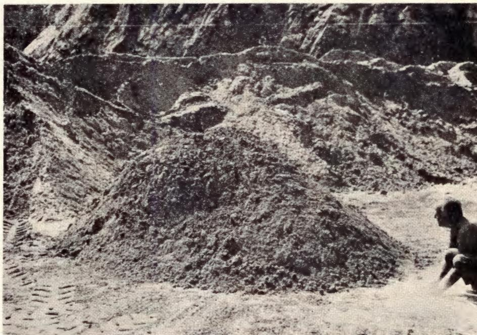
*Figura 6.- La arena de un montón, recubriendo el cañon de aire, es proyectada como si fuera un volcán por la descarga de aire comprimido.*
