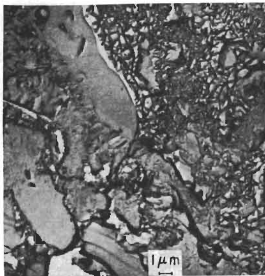
Fig. 2 — Microestructura de una pasta de SC_3 - Al_2O_3 - yeso , atacada con glicol durante 1/2 hora, a los 6 meses de edad. De T. D. CIACH, y E. G. SWENSON, en "Cement and Concrete Research" (1971), vol. 1 n° 3.
