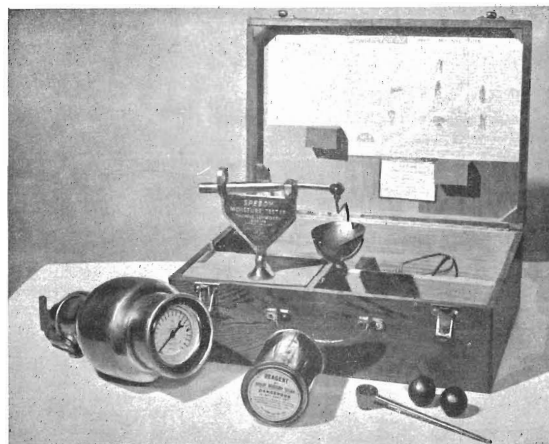
Figura 1. — Equipo para determinación de humedades por el método del carburo de calcio. Disposición de los elementos de medida.
