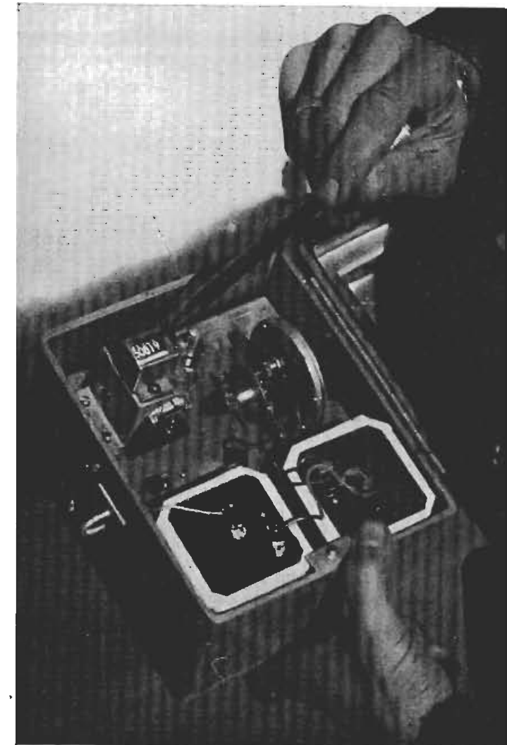
Figura 2 -- Vista del aparato. Con el lápiz se señala el registro contador. Estos aparatos adquiridos por nuestra Dirección son únicos en el país.
