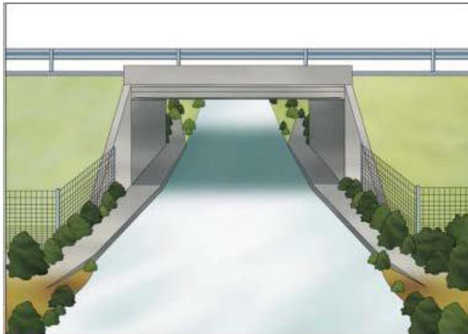
Figura 62 - Esquema general de un drenaje adaptado para animales terrestres
